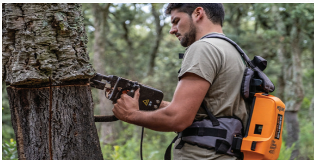
Imagen 5. Máquina COVELESS 3C18 durante la fase de trazar. Fuente: Institut Català del Suro.
